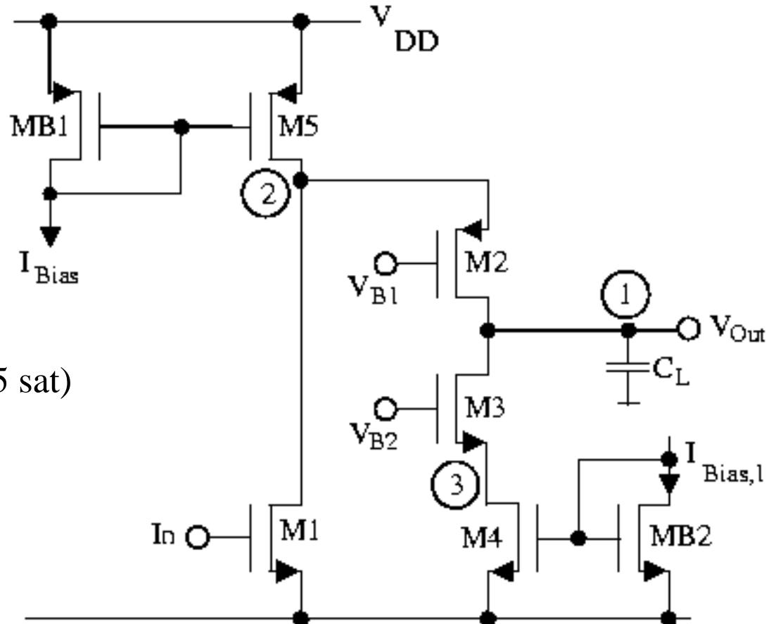
$$G_m = g_{m1} \quad ; \quad r_{out} \cong \left( r_{ds2} g_{m2} \left( r_{ds1} \parallel r_{ds5} \right) \right) \parallel \left( r_{ds3} g_{m3} r_{ds4} \right)$$
