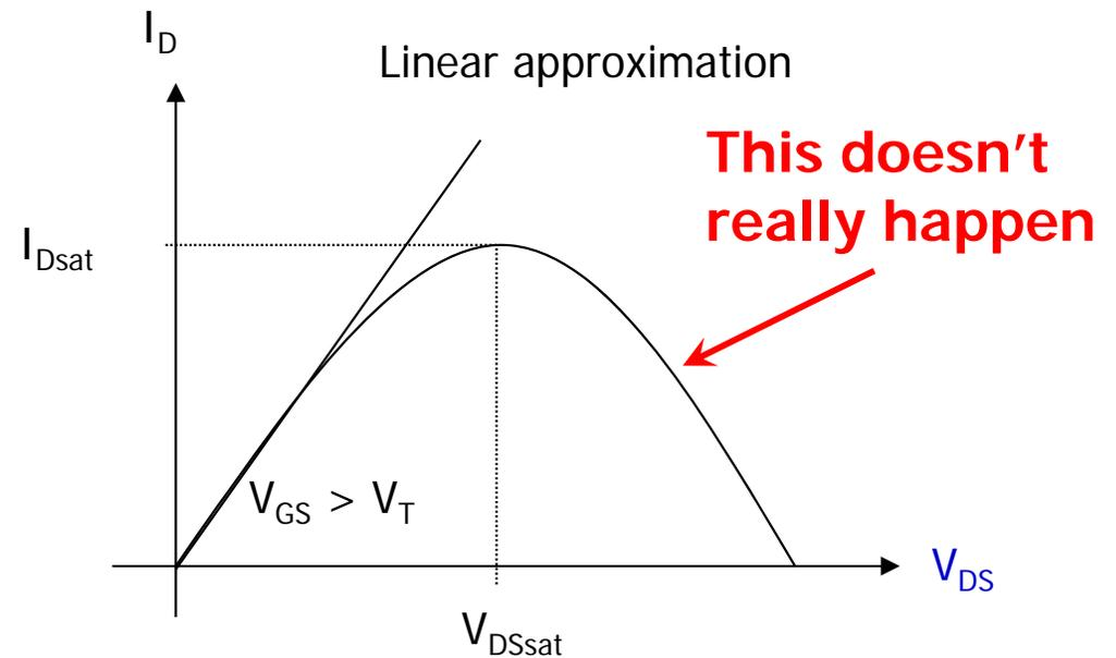
$$V_{DSsat} = V_{GS} - V_{Tn}$$
