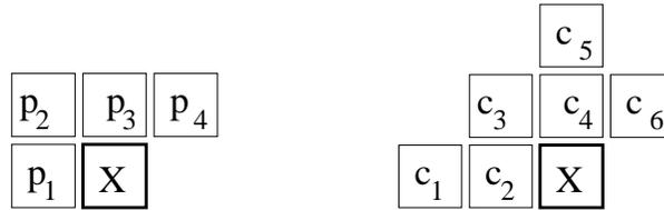
**Abbildung 1.** Im Programm LBC werden nur direkt benachbarte Werte  $p_1, \dots, p_4$  zur Prädiktion des Wertes  $X$  verwendet. Auf der rechten Seite ist die zur Codierung benutzte Umgebung abgebildet.
